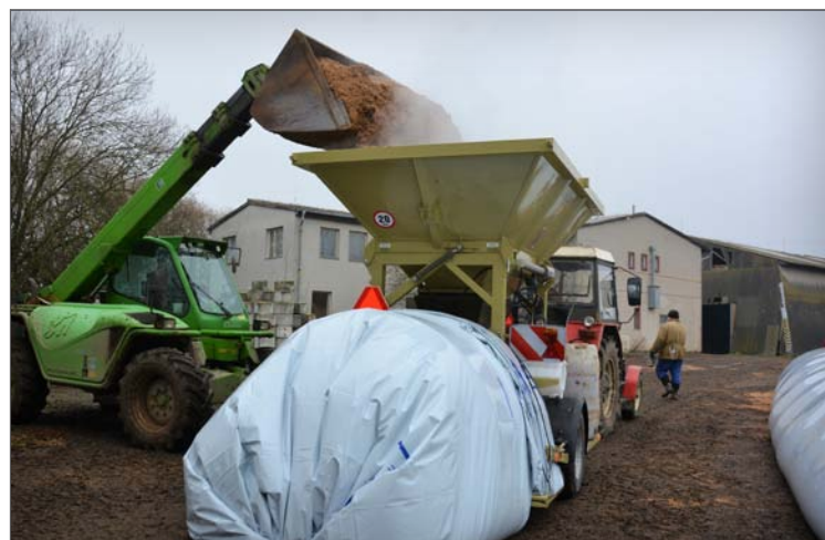
Silážování pivovarského mláta vakovačem
